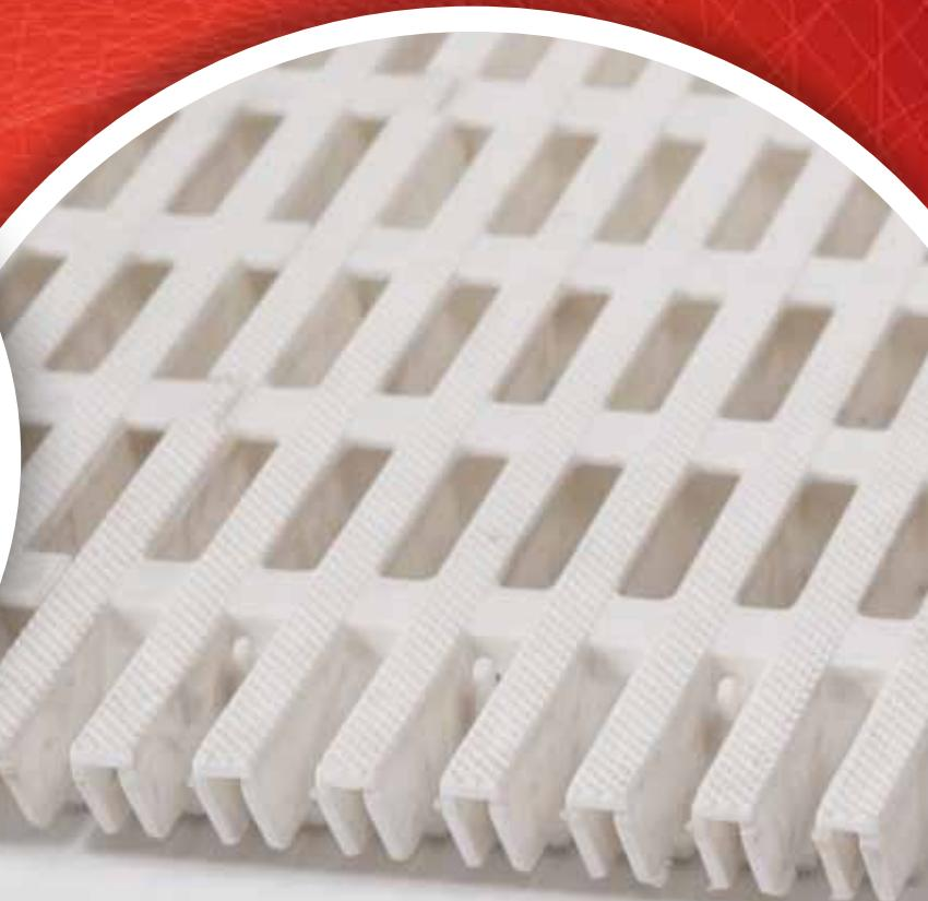
Fabricadas en polipropileno copolímero de alta calidad, con superficie calada con ranuras de 36 x 7 mm. para el posible desagüe de líquidos.
